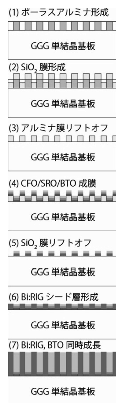
図2 マルチフェロイック複合膜の形成プロセス
