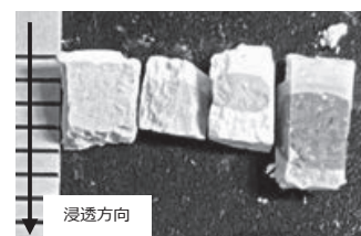
写真1 試料中央の断面 (左から48h, 190h, 336h, 504h)
