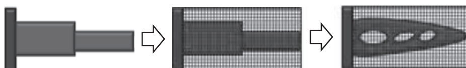
図4 構造物のトポロジー最適化
