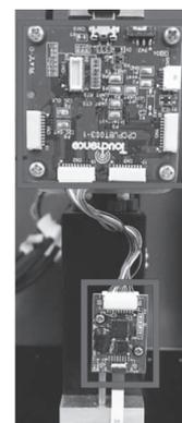
図5 計測回路の取付状態
