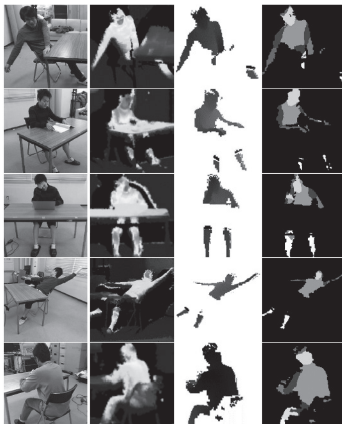
図7: 実シーンでの姿勢推定結果:左から右へそれぞれ,シーンの画像(推定には用いない), 熱距離画像, 人物領域の距離データ, 推定結果を示している
