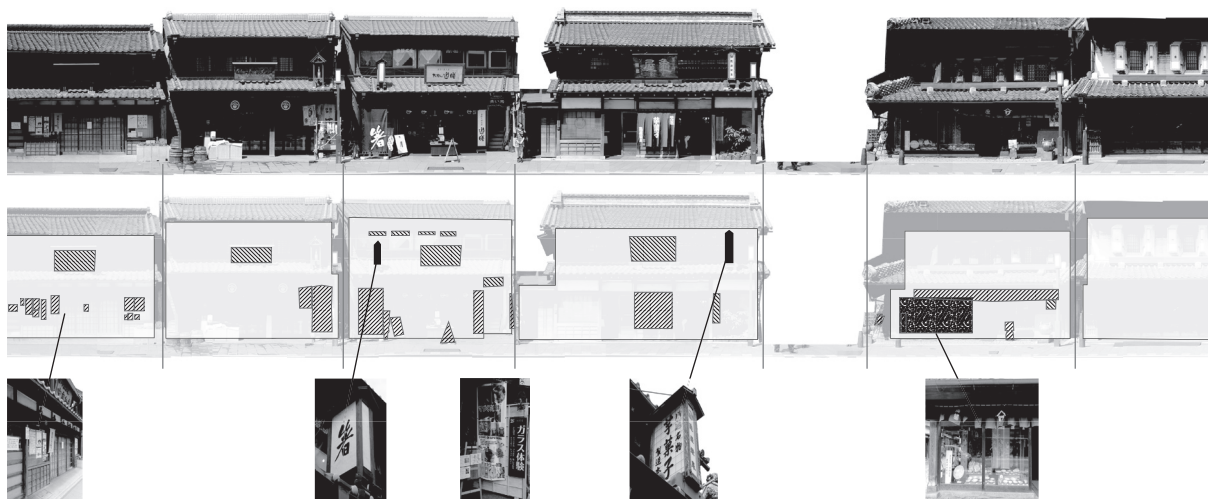
図6 川越市川越 伝建地区内の調査図（調査の一部：上から連続立面、分析図，広告物の様子）
