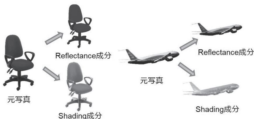
図10 写真をIntrinsic Image技術で反射成分と陰影成分に分解
