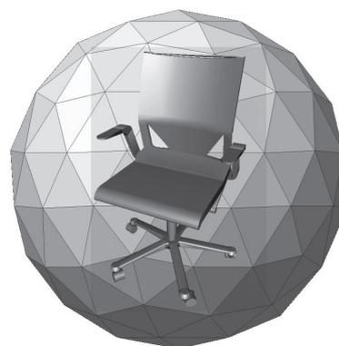
図3 3Dモデルは、姿勢正規化後、102面の三角形で近似した測地線球 (geodesic sphere)で囲み、各三角形の頂点と球の中心を結ぶ方向に投影することでレンダリングを行う
