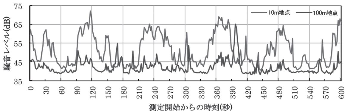
図6 起点と終点付近の騒音レベルの経時変化
