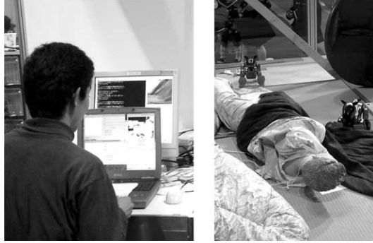
図3 遠隔操作により被災者を探査するロボットの操作インターフェース(左)、現場でのAIBOと被災者(右)【ロボカップジャパンオープン2004会場にて】
