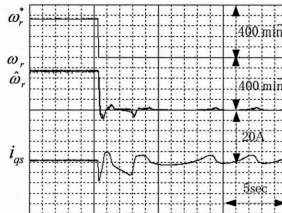
図7 オブザーバゲインを用いた時の速度ステップ応答（無負荷）
